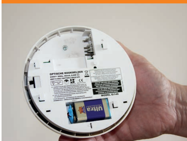
Na het verwijderen van de rookmelder van zijn montageplaat kan de back-upbatterij worden vervangen.
