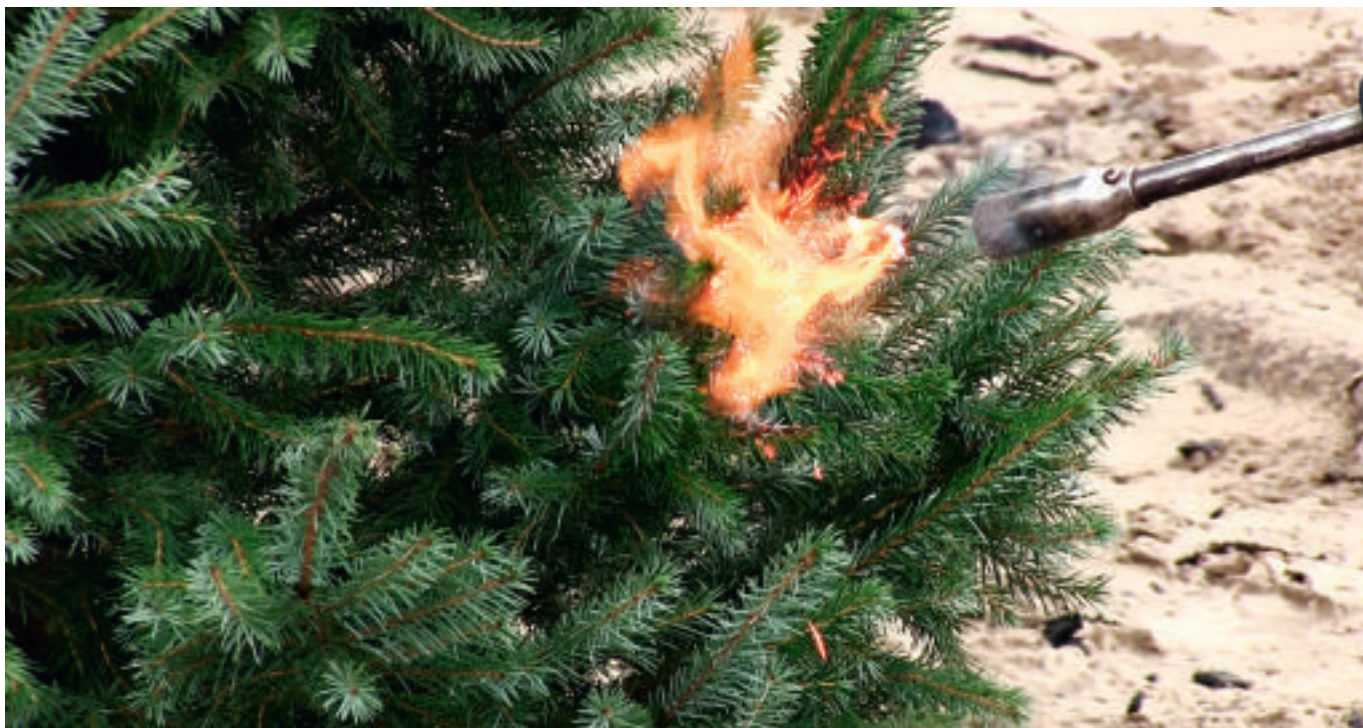
Gedrag van een geïmpregneerde en een verse kerstboom na 30 seconden blootstelling aan een vlam.
